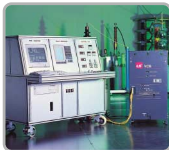
Проверка характеристик вакуумного автоматического выключателя
