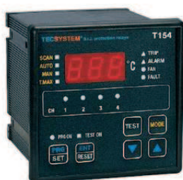
Реле контроля температуры T-154 (с on-line мониторингом температуры, сигнал на реле поступает от датчиков РТ-100)
