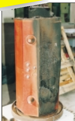
Катушка трансформатора Trihal после испытания F1
