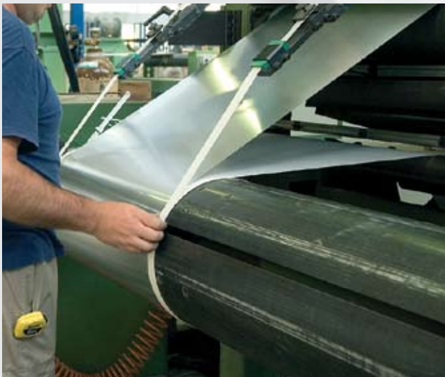
Намотка обмотки низкого напряжения
